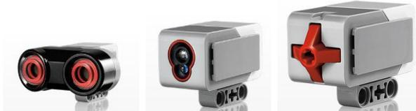
Датчик касания    Ультразвуковой датчик    Датчик цвета
